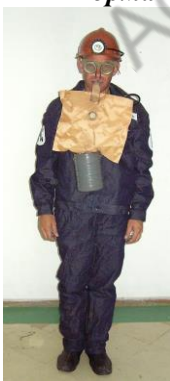
Рис. 48. Включение в самоспасатель ШСС- 1, ШСС-Т
