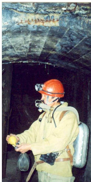
Рис. 78. Отбор пробы рудничного воздуха в резиновую камеру
