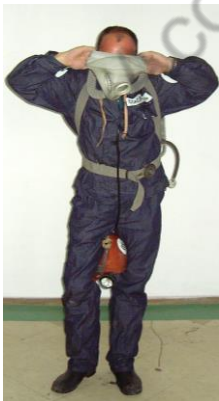
Рис. 47. Очередность надевания респиратора с шлемом-маской
