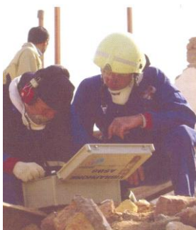
Рис. 176. Оператор с акустическим прибором «Пеленг - 1»
