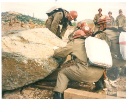
Рис.205. Применение пневмомократов типа «пневмоподушка»
