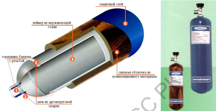
Рис. 22. Безосколочный металлокомпозитный баллон высокого давления
