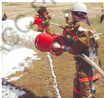
Рис. 119. Применение генератора пены ГПС-600
