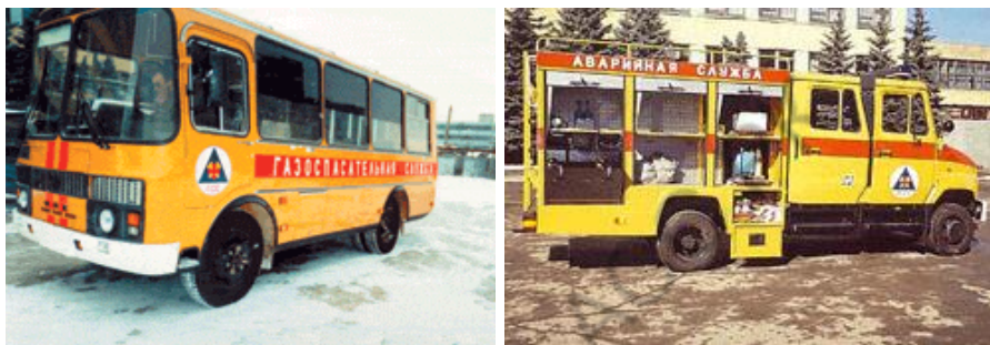
Рис.173. Автомобиль газоспасательной службы на базе ПАЗ, ЗИЛ
